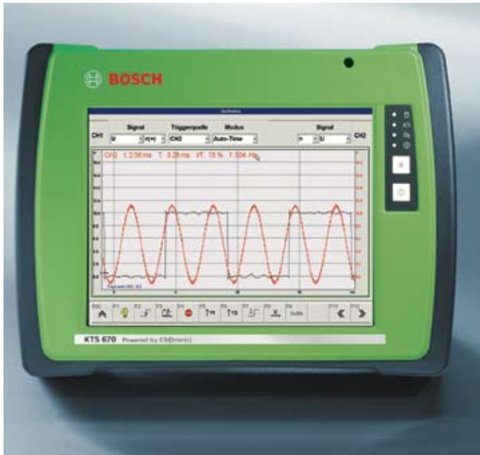
KTS 670: 2-kanaals oscilloscoop om storingen snel op te sporen
